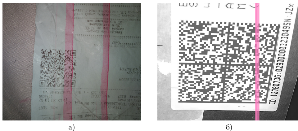
Рис. 4. Дефект печати в виде красной полосы: а) реальное изображение, б) синтезированное изображение с наложением аугментации.
